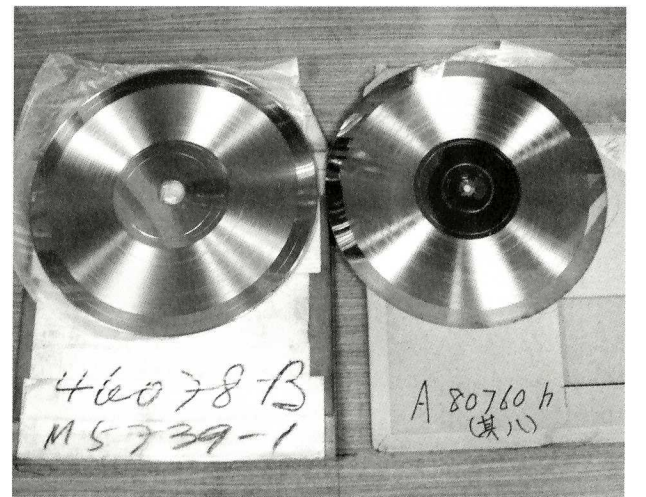
「原盤」には、溝の凹凸が逆のものを含め、いくつかの種類がある
