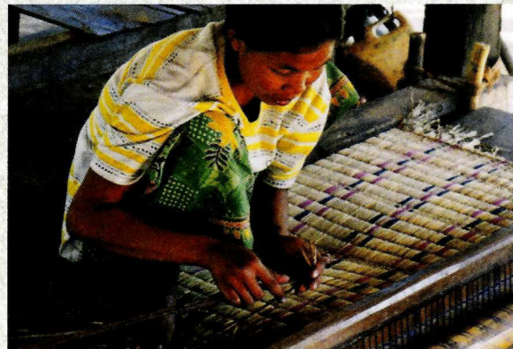
カヤツリグサの茎を1本ずつ、添木を使って 縦糸のあいだをとおしていく
