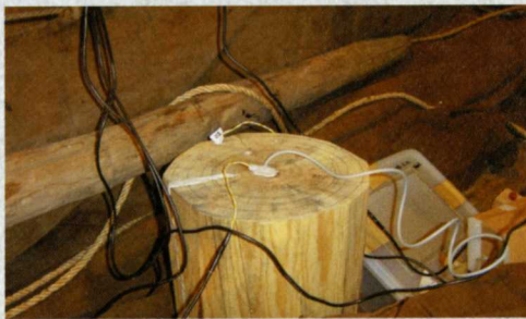
(写真5) 実験用丸太を使い、木材芯部の温度推移を測定する
