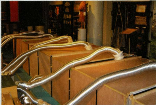
(写真4) 南アジア展示場での漁船の高温処理(2003年3月)。左手は熱発生装置、右手の断熱箱のなかに防湿プラスチックシートで密封された漁船が入っている
