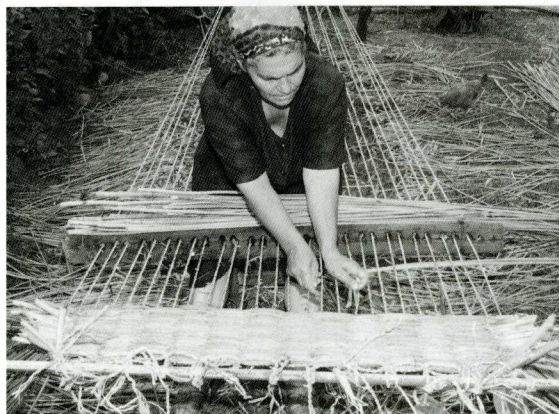
(写真6)アゼルバイジャンでは円い孔がつけられた緯打具を使ってゴザを織る
