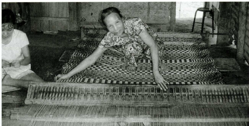
(写真3)ベトナムで見られる複合式開孔板綜統によるゴザ織り
