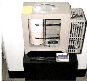
(写真4) 収蔵庫に設置した自記温湿度計とデータロガー
