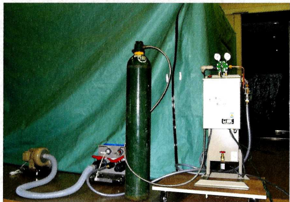
(写真3) 二酸化炭素処理システム
