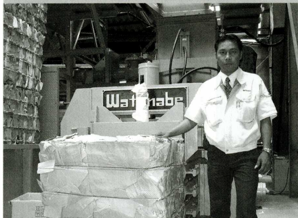
会社で設計した機械の前で。 この機械は資源廃棄物(紙や缶)などを つぶすために使われている
