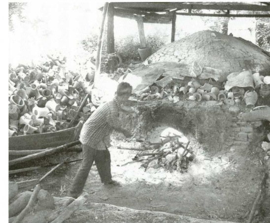
長い棒を使って、窯に木の枝を押し込む。 雨期でも作業をするため、窯には屋根がある
