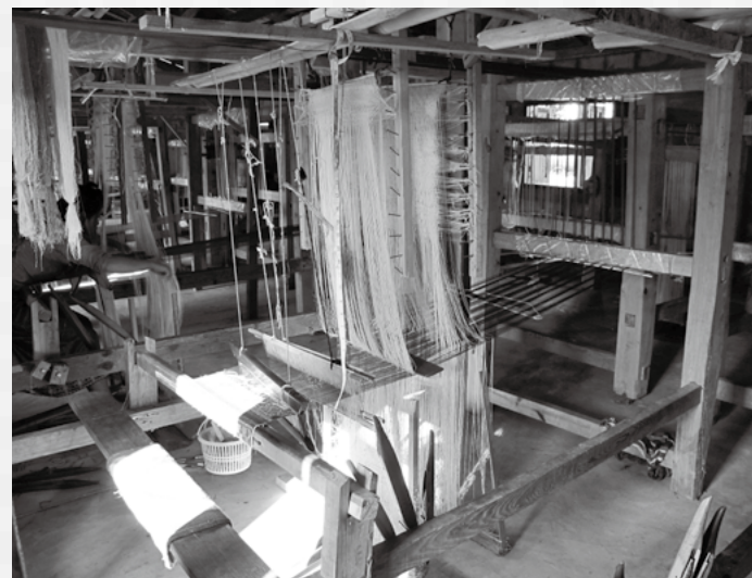
複雑な紋様を織るためのタテ糸に直交する綜絢(垂直紋綜絢)が2組備わった、ラオの枠機。ラオス、シェンクワン県 (撮影・柳 悦州)
