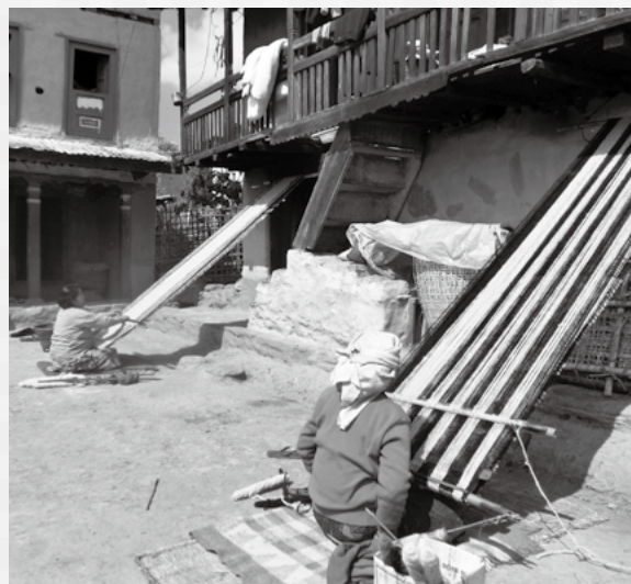
腰機で全周約6メートルの輪状の布を織るグルン女性たち。織り上がった羊毛織物は、フェルト状に加工してから販売される。ネパール、オカルドゥンガ郡ルムジャタル村 (撮影・上羽陽子)
