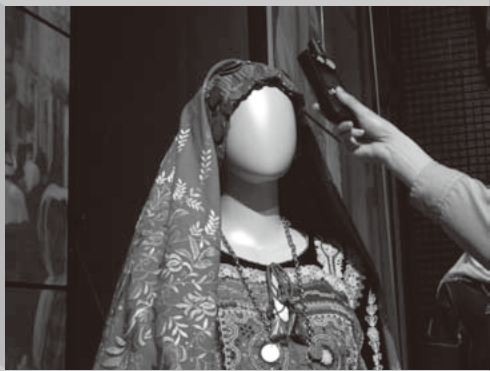
展示場での照度測定。照度は、もっとも光があたっているところで測定する
