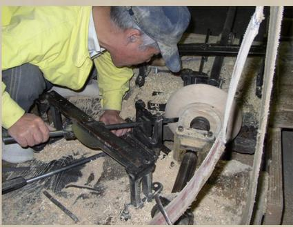
ドウスの付いた鉋をスリガタに押し当て、刃先が正確な位置に対応しているかを点検中
