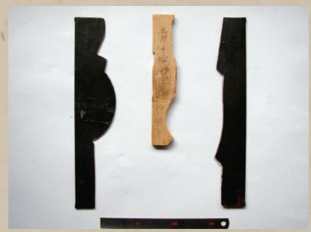
スリガタ(外側用・内側用)とアイガタ(中央)。アイガタは椀の口径や糸尻の径、側面のカーブを記録した物差しである
