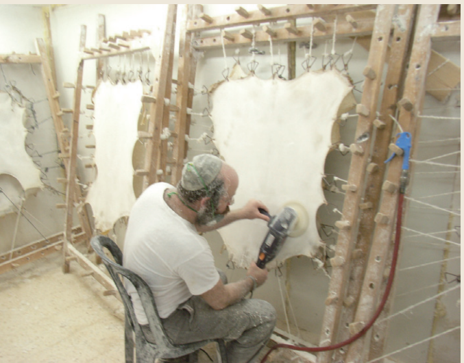
電動グラインダーで削る現代の工場（イスラエルのベト・シエメシユ）
