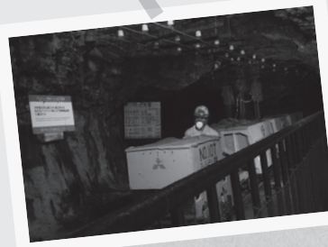
史跡尾去沢鉱山の観光坑道内に展示されている鉱石運搬のための蓄電池式機関車
