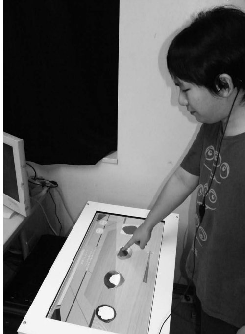
食感シミュレーター 食感シミュレーターは、利用者に食品の咀嚼音を聴かせ、食感を再現するものである。骨伝導ヘッドホンを使うことで、より本物に近い咀嚼音を聴くことができる。噛んだ音や振動をモデル化して、更にリアルな食感を再現することが今後の目標である
