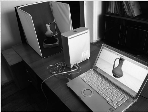
発掘調査で出土した考古遺物のレーザースキャナを用いた3次元計測の様子 【実際の土器の形がコンピュータに読み取られていく様子がわかる】
