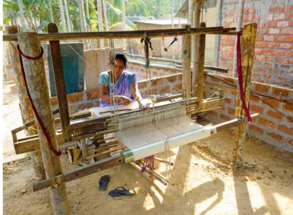
エリ蚕糸による手織り風景。タテ糸は切れにくい工業製糸、ヨコ糸は手紡ぎ糸を用いている(2016年)
