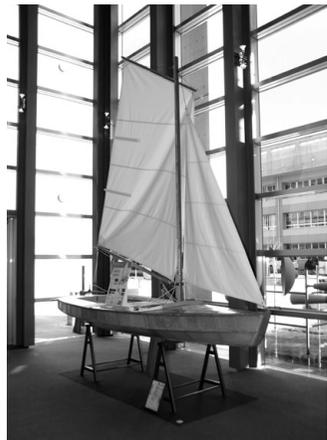
2015年度に卒業した学生の卒業制作作品。団塊の世代へむけた、操船がこないやすいヨットの提案(サイズ:長さ約3,800mm、巾約1,500mm、高さ約3,900mm)
