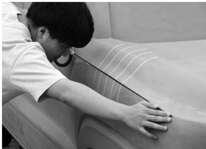
フルサイズモデルを用いたカーデザイン。フェンダー形状の検討風景(2018年)
