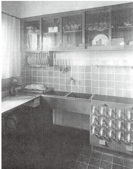
フランクフルト・キッチンの外観。作業台、シンク、小麦や砂糖などを入れる棚などが見える(出典:Noever, Die Frankfurter Küche von Margarete Schütte-Lihotzky, 1992, S. 15.)
