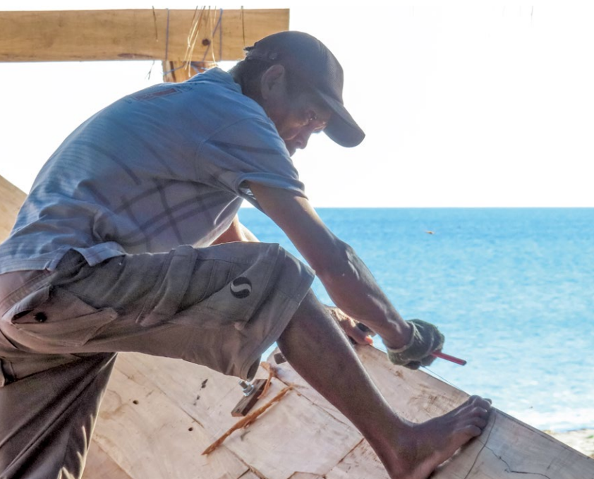
船体の板材に墨付けをおこなう船大工(2022年)
